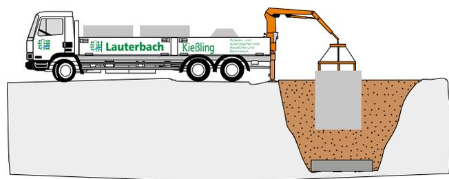
Sämtliche Regenwassersammelschächte (mit Ausnahme des 15 m<sup>3</sup> Monolithschachtes) können direkt vom LKW in die Baugrube gesetzt werden, wenn eine einwandfreie Zufahrt gegeben ist.
