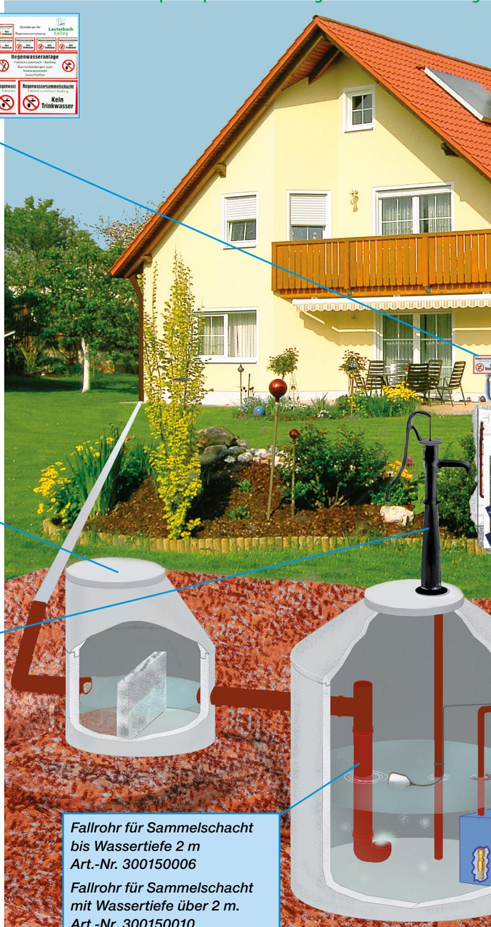
Fallrohr für Sammel-schacht bis Wassertiefe 2 m
